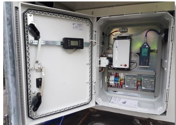
Abb. 4: Messgerät und Modemeinheit:
